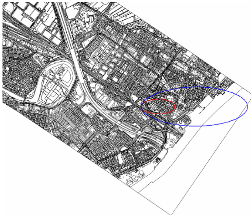
Figuur 5-11 Schadegebied bij het scenario instantaan vrijkomen ammoniak of chloor (locatie Zwijndrecht, rood 1% letaliteitgebied ammoniak, blauw 1% letaliteitgebied bij chloor)[26].
